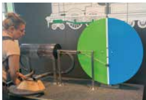
ピストンの往復運動を車輪の回転運動に変えます。
